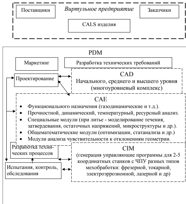
Рисунок 1. Структура взаимодействия между компьютерными системами на различных этапах жизненного цикла изделия
