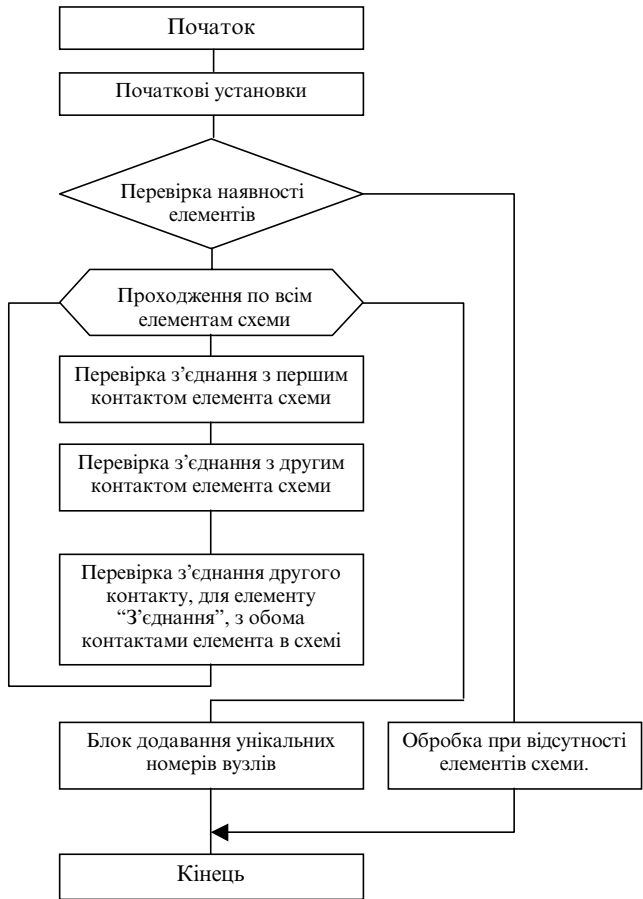
Рисунок 3. Структурна схема алгоритму автоматичного з'єднання елементів та нумерації вузлів
