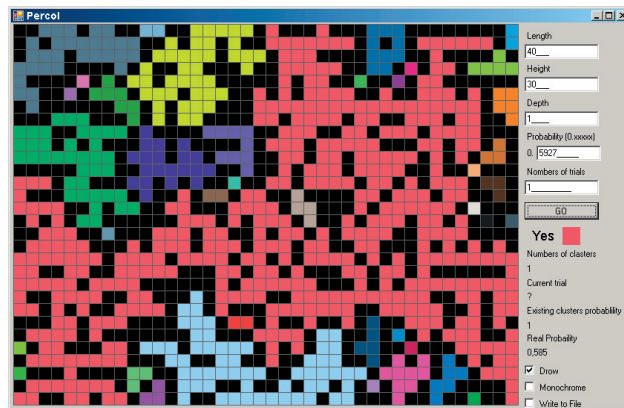
Рис. 1. Приклад розрахунку ймовірності появи з'єднуючого кластера для двовірної моделі при різних ймовірностях заповнення електропровідним компонентом ( L = 40, H = 30 )
