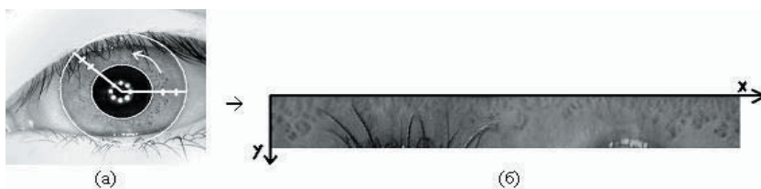
Рис. 4. Пример перевода радужки из полярных координат (а) в декартовы (б)
