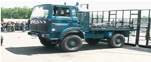
Рис. 3. Мобільна система загороджень на базі автомобільного шасі
