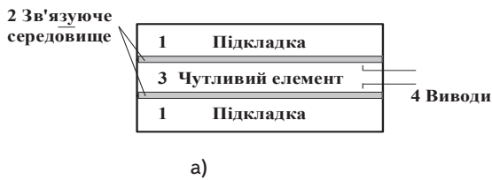
Рис. 1. Загальний вигляд перколяційного ТЛД: а) до навантаження; б) після навантаження
