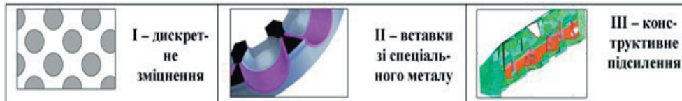
Рис. 1. Схеми варіантів зміцнення елементів військової та цивільної техніки
