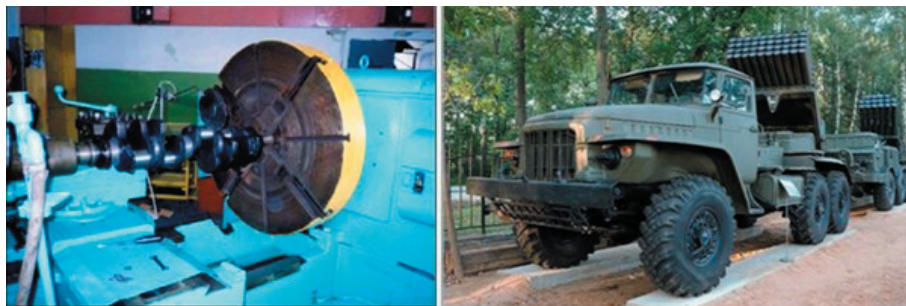
Рис. 2. Дискретно зміцнений колінчастий вал двигуна КамАЗ-740 для оснащення двигуна шасі установки «Град»
