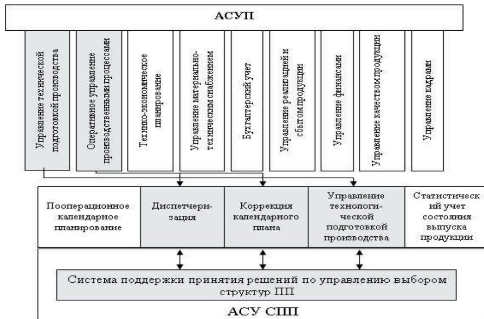
Рис. 2. Схема функциональных связей компонентов АСУП, АСУ СПП и СППР по выбору структур ПП
