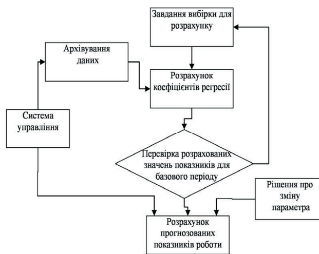
Рис. 7. Схема отримання прогнозованих значень показників роботи дифузійної станції
