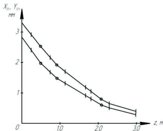
Рис. 5. Зависимость амплитуд от координаты  $z$ :  $a = 0,68$  м;  $b=0,96$  м;  $m=720$  кг
