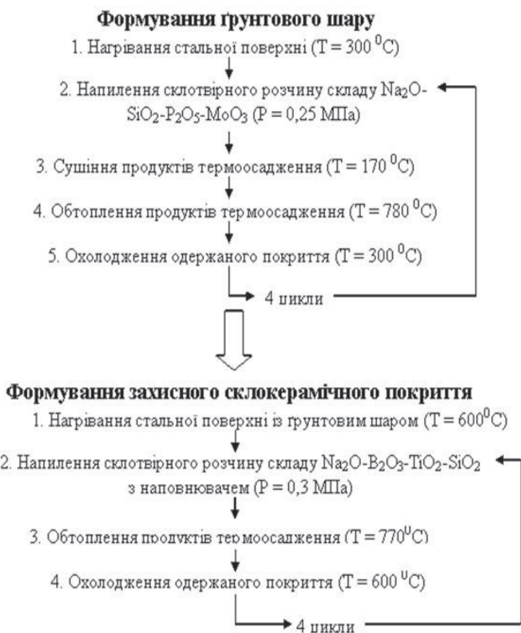
Рис. 1. Загальна схема одержання захисного двошарового склокерамічного покриття
