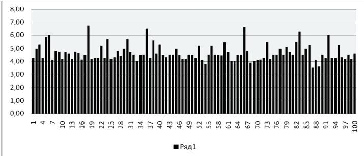
Рис. 1. Гистограмма собственных частот случайной выборки пьезоэлектрических пластин
