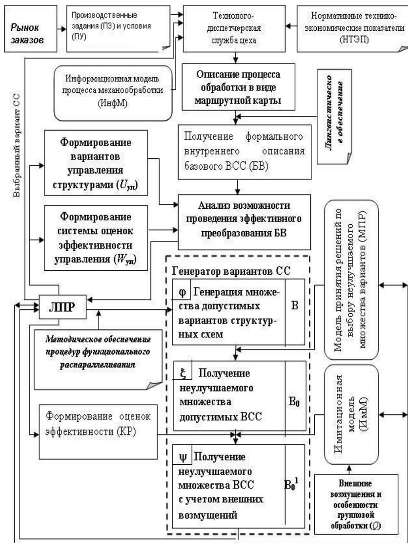
Рис. 1. Структурная схема поиска решения модифицированной задачи управления выбором структур процессов механообработки
