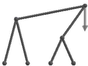
Рис. 4. Стержневая система, из шести стержней с нагрузкой на верхний узел
