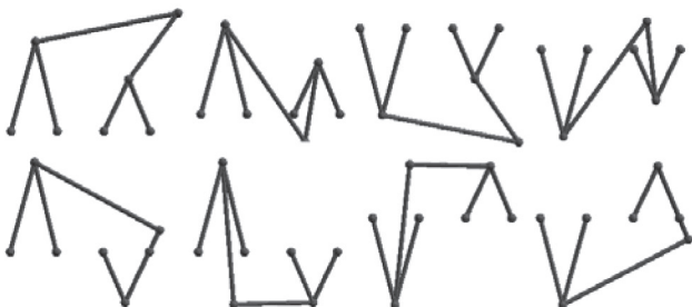
Рис. 2. Возможные состояния устойчивости стержневой системы без нагрузки
