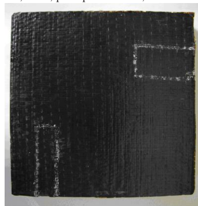
Рис.3. Схема расположения дефектов в образце.
