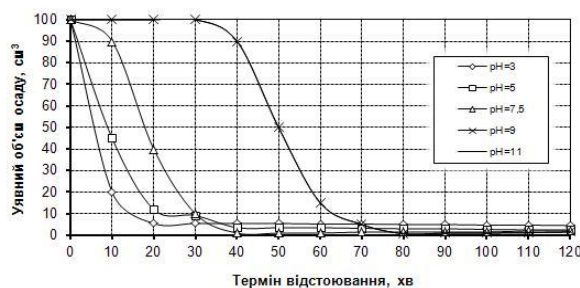
Рис. 3. Залежність уявного об'єму осаду (см 3 ) часток бентоніту від терміну відстоювання (хв) при додаванні до суспензії флокулянту Magnafloc 156 дозою 5 мг/г осаду при різних значеннях водневого показника (початкова концентрація часток бентоніту C_{т.ф.} = 26 \text{ мг/дм}^3 )
