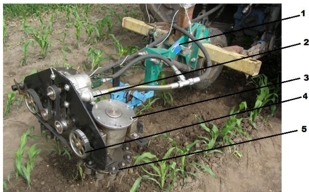
Рис. 3. Опытная установка для междурядной обработки почвы с ротационными рабочими органами: 1 – проволочный тензодатчик; 2 – система гидропривода дисков рабочего органа; 3 – редуктор; 4 – механизм передачи крутящего момента; 5 – рабочий орган
