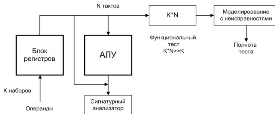
Рис. 1. Структурная схема функционального самотестирования
