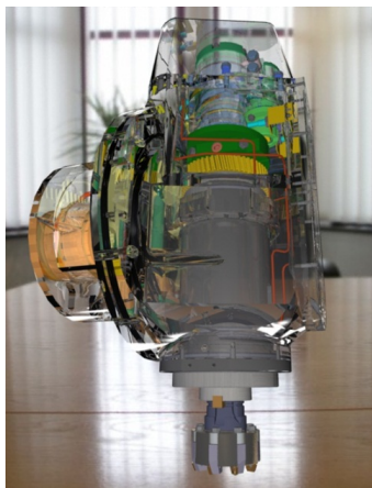
Рис. 3. Шпиндельная бабка станка СВМ1Ф4: а – разрез шпиндельной бабки; б – рендеринг в модуле Artisan Rendering
