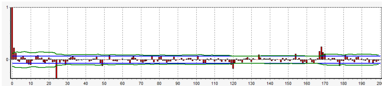
Рис. 16. Автокорреляционная функция временного ряда потребления электроэнергии (n=840; k=200)
