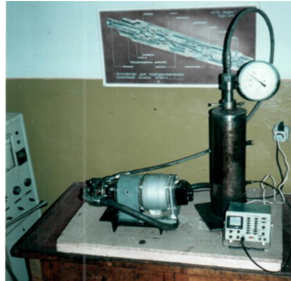
Рис. 3. Фотографія лабораторного стенду для дослідження роботи гідродинамічного пульсатора
