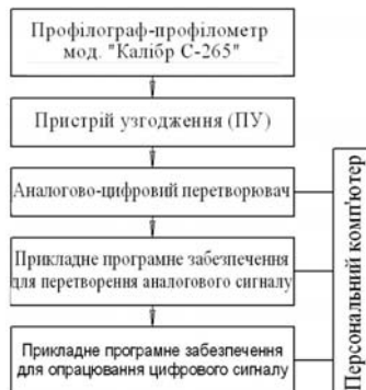
Рис. 7. Принципова схема вимірного комплексу для проведення експериментальних досліджень
