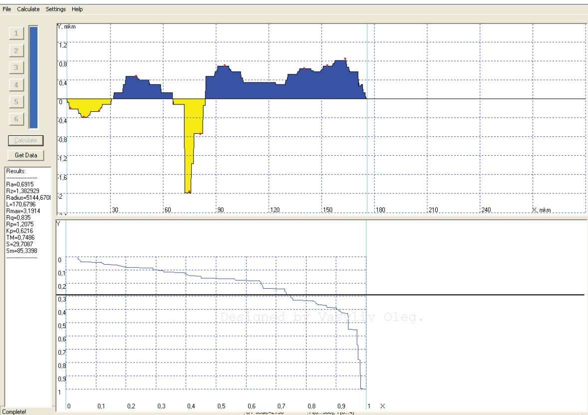
Рис. 9. Результати комп'ютерного опрацювання мікрорельєфу поверхневого шару: а – профілограма відправної поверхні; б – профілограма поверхні з нанесеним твердосплавним покриттям
