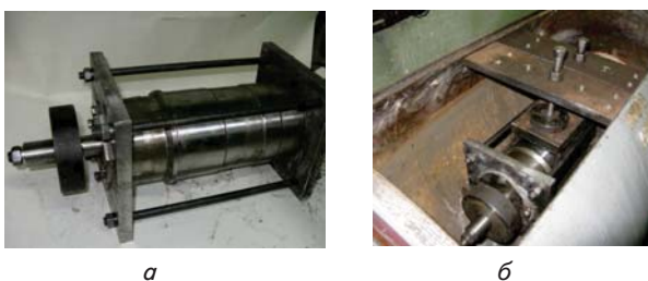
Рис. 6. Технологічне оснащення для вібраційно-відцентрового зміцнення внутрішніх поверхонь циліндричних виробів на вібромашині об'ємного оброблення: а – вібраційно-відцентровий обкатник із циліндровою втулкою, б – обкатник із технологічним оснащенням у вібромашині
