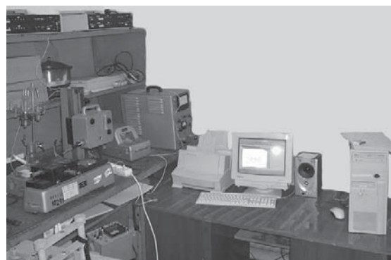
Рис. 8. Комплекс для вимірювання геометричних параметрів якості поверхні виробів
