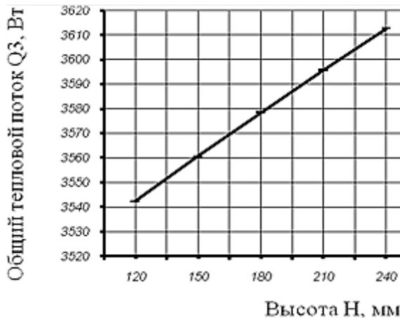
Рис. 3. Влияние высоты корпуса отражателя на общий тепловой поток излучением
