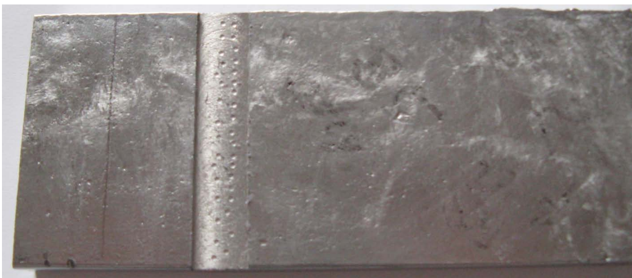
Рис. 5. Експериментальний зразок із замірами твердості профрезерованої площини
