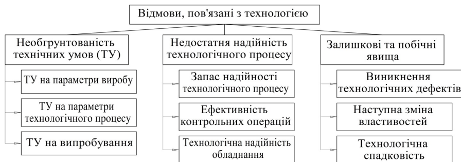
Рис. 3. Класифікація недопустимих відмов, пов'язаних із недосконалістю технологічних процесів [4]
