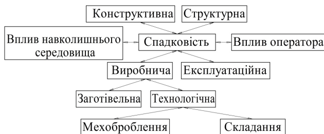
Рис. 1. Різновиди спадковості у життєвих циклах машини та інженерії поверхні [6]
