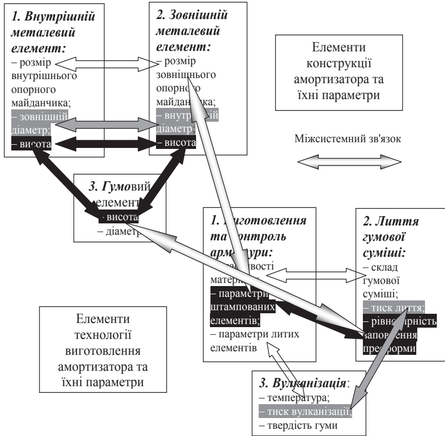
Рис. 5. Параметри елементів конструкції гумометалевого амортизатора та технології його виготовлення, які оптимізуються при комплексному проектуванні, та приклади системних та міжсистемних зв'язків між ними
