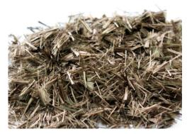
Fig. 2. Basalt fiber
