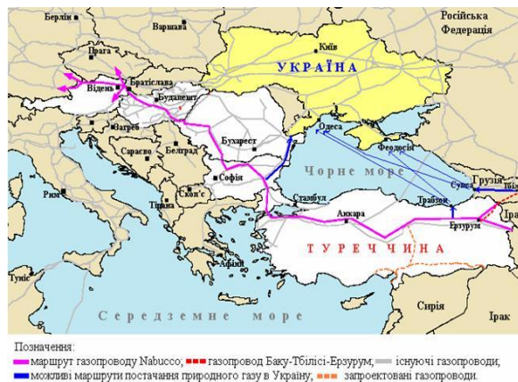
Рисунок 1 - Маршрут газопровода і можливі варіанти постачання природного газу в Україну з використанням болгарського і турецького участків газопровода
