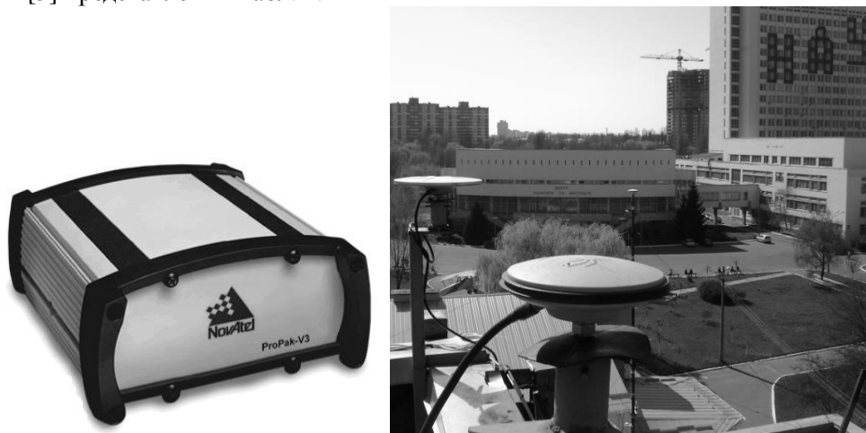
Рис. 1. Зовнішній вигляд навігаційного приймача ProPak – V3 та його антени
