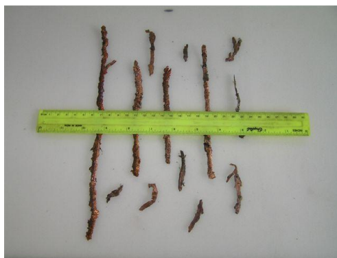
Рис.3. Осколки, образующиеся при взрыве кумулятивного заряда, перехваченные эластичной взрывозащитной камерой.
