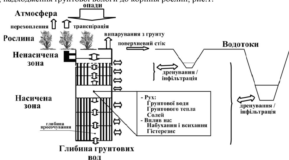
Рис. 1. Схематичний вигляд переміщення ґрунтової вологи в природі.
