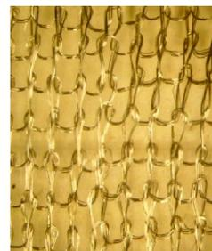
Рис. 5. Медная сетка трикотажной структуры типа «ластик»
