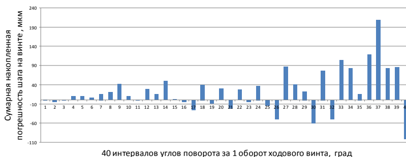
Рис. 3. Зависимость суммарной накопленной погрешности шага нарезаемой резьбы от поворота ходового винта на заданный угол.
