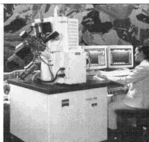
Рис.2 - Установка Cross Beam 1540 – комплекс для создания и исследования нанобъектов
