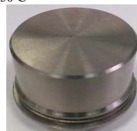
Рис.7. ЧЭ ЦВГ діаметром резонатора 43 мм.
