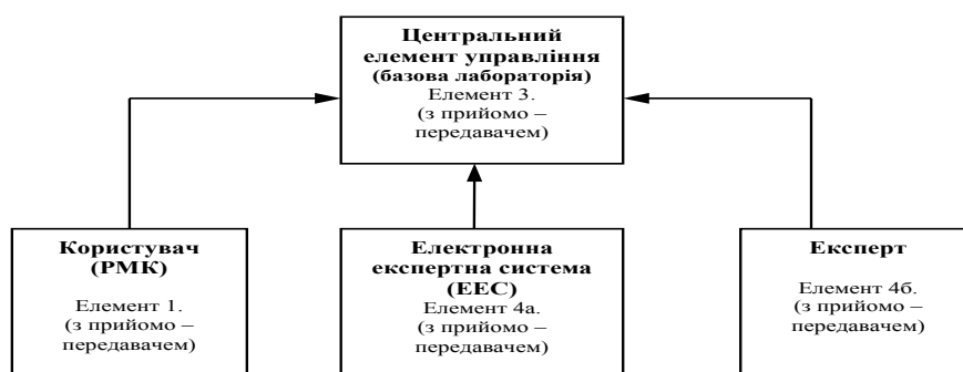
Рис. 4. Фрагмент 1 структурної схеми тІС «ЕкоІС» для екомоніторингу, стеження за міграціями комах [8]
