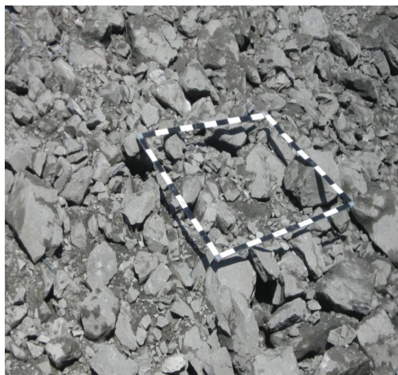
Рисунок 5 – Замер гранулометрического состава взорванной горной массы
