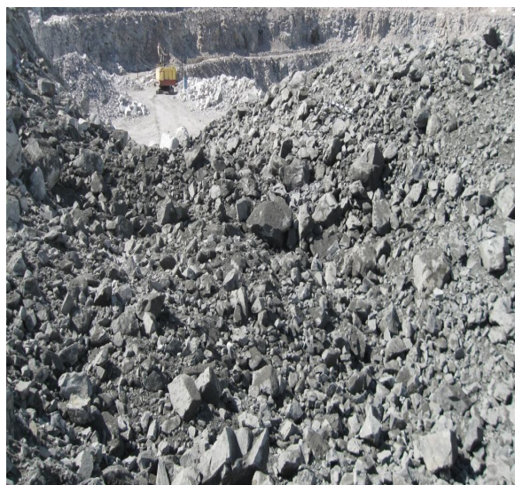
Рисунок 4 – Общий вид развала взорванной горной массы
