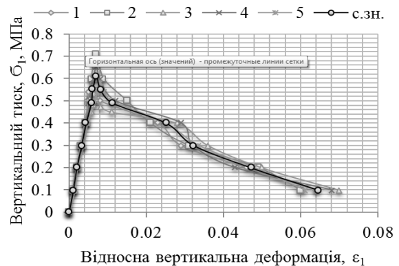
Рисунок 1 – Результати випробування глинокомпозиту в умовах одноосного стискання; 1–5 – результати випробувань по зразкам; с.зн. – середнє значення
