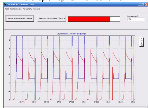
Рисунок 8 – Определение КЗ витков, статор из поврежденной обмоткой
