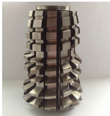
Рисунок 1 – Черв'ячна фреза з поділенням по висоті на три частини профілем інструментальної рейки t=3 мм, Z=12 , d_a=58,5 мм
