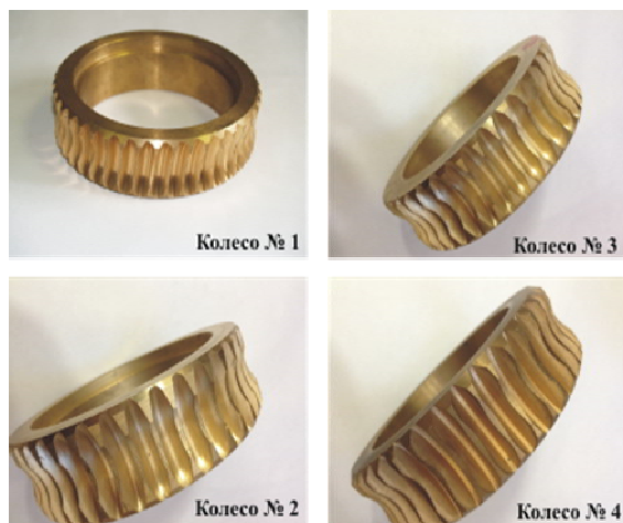
Рисунок 2 – Отримані в результаті експериментів черв'ячні колеса
