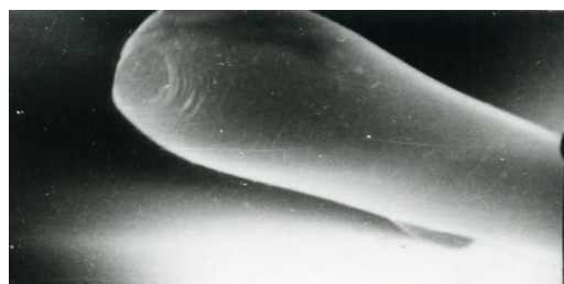
Система KCl-KF-K_2Ti_6O_{13} размер включения 1–2 мкм
