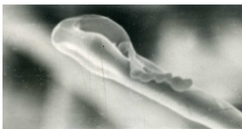
Система KCl-NaCl-\Sigma TiCl_n размер включения 1–2 мкм
