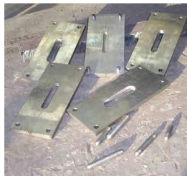
Рисунок 4 – Оснастка в собранном виде, установленная на прессе и комплект экспериментальной оснастки
