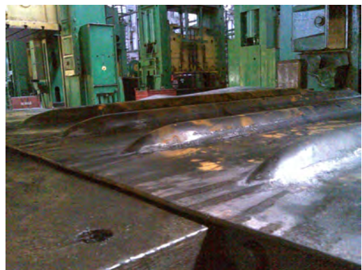
Рисунок 1 – Отштампованная деталь с гофрами у законцовки рифта
