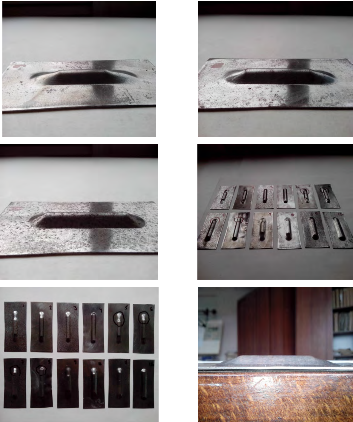
Рисунок 5 – Экспериментальные образцы после формовки рифта
