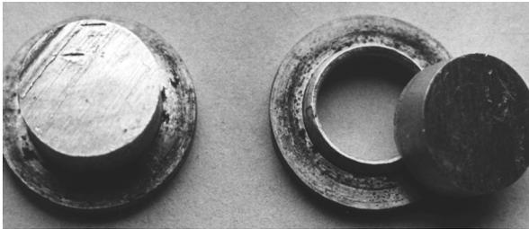
Рисунок 3 – Образцы для испытания биметаллических соединений
