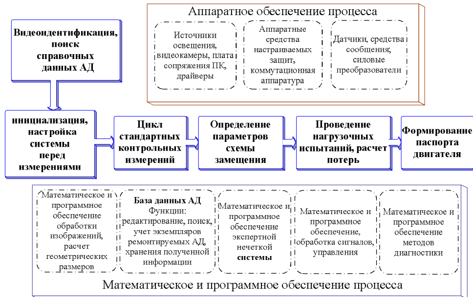
Рисунок 1 – Схема автоматизированного процесса испытаний асинхронных двигателей приложения
