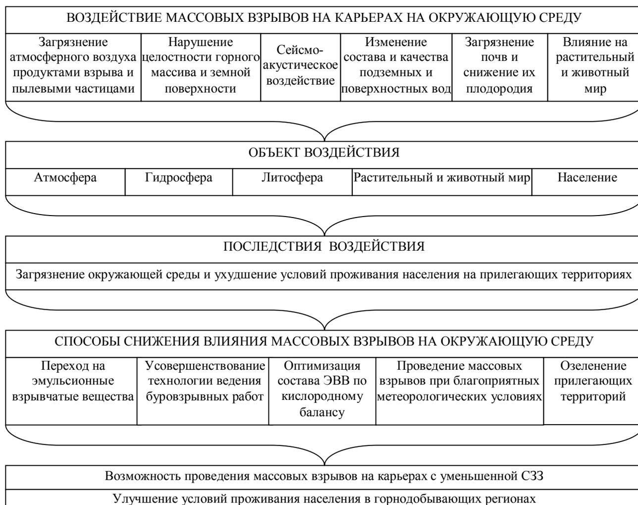
Рисунок 1 – Основные виды и объекты воздействия массовых взрывов на карьерах на окружающую среду и мероприятия по их минимизации
