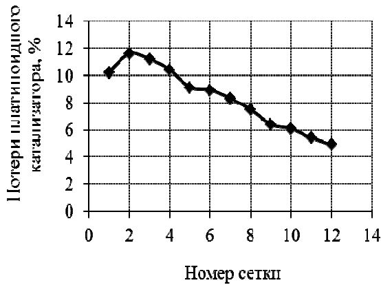
Рисунок 1 – Изменение массы сетки от номера в комплекте для сплава ( 95 % – Pt, 5 % – Rh)
