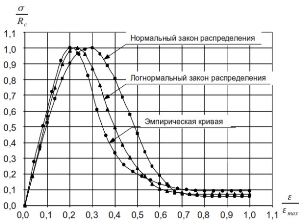
Рисунок 6 – Кривые деформирования за пределом прочности мартито-кварцито-гематитовых роговиков
