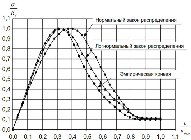
Рисунок 7 – Кривые деформирования за пределом прочности руды краско-мартитовой
