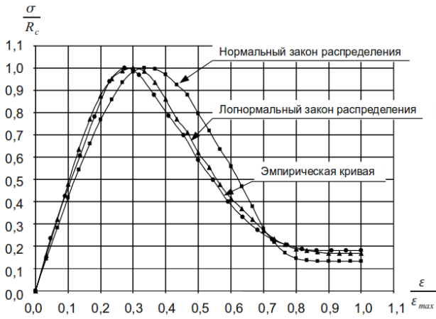
Рисунок 5 – Кривые деформирования за пределом прочности кварцево-гидрогематитобитовых сланцев
