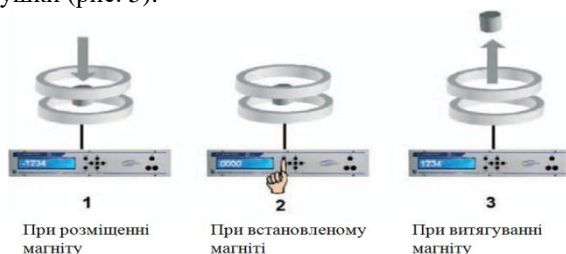
Рисунок 5 – Контроль якості постійних магнітів з використанням котушки Гельмгольца
