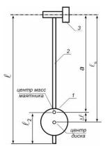
Рисунок 3 — Общий вид и схема баллистического маятника: 1 — диск маятника; 2 — трубка тонкостенная; 3 — переменный резистор СП-1
