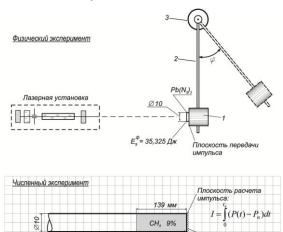
Рисунок 1 — Схема физического и численного эксперимента: 1 — металлический диск; 2 — трубка тонкостенная; 3 — переменный резистор СП–1
