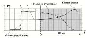
Рисунок 4 — График параметров течения продуктов взрыва из тупиковой части камеры (вдоль оси камеры Z) в численном эксперименте на момент времени 80 мкс: 1— график давления газов P; 2— скорость течения газа U
