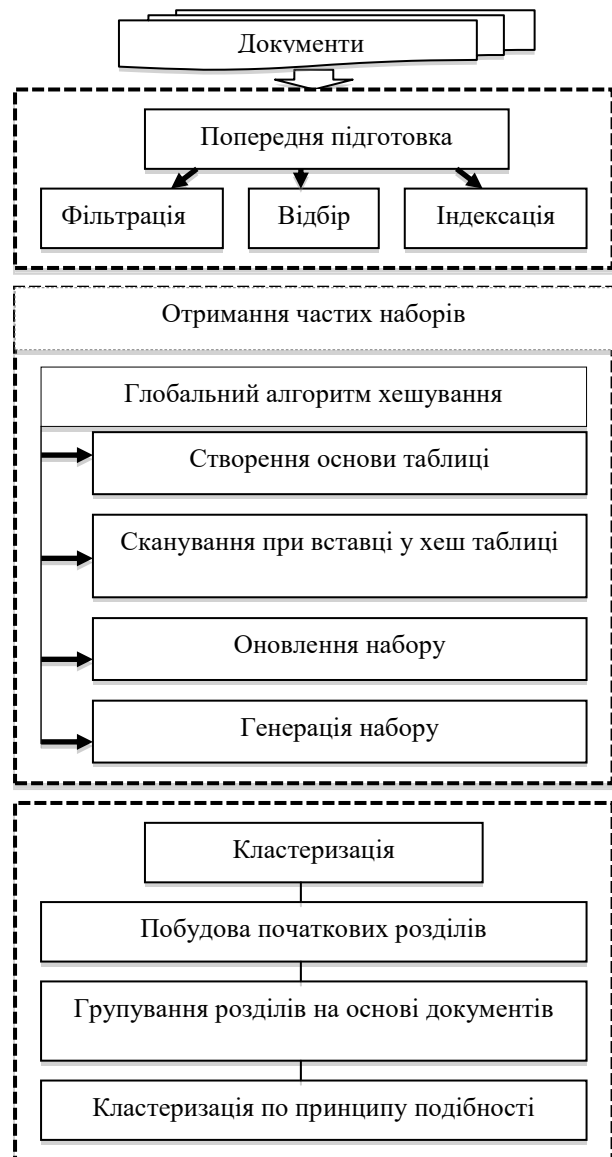
Рисунок 1 – Структурна схема процесу кластеризації веб-документів на основі алгоритму хешування для отримання частих наборів
