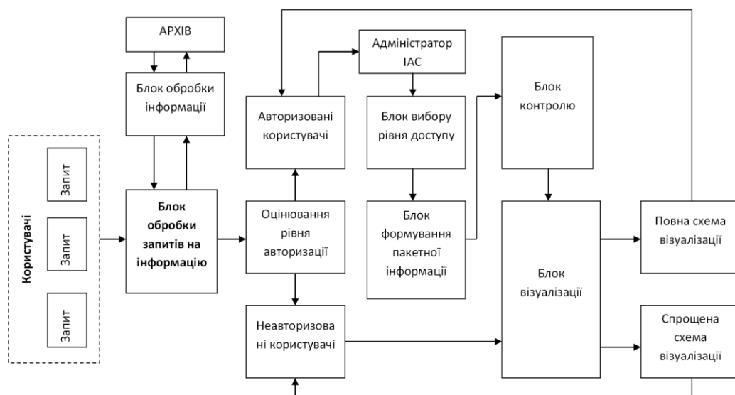
Рисунок 7 – Структура ІАС у частині обробки запитів на інформацію та її візуалізації
